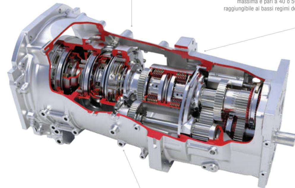
Dyna-6 Super Eco offre sei marce in Powershift e quattro gamme per la massima facilità di gestione sul campo e sulla strada. Un totale di 24 velocità in entrambe le direzioni significa che è disponibile una velocità adatta praticamente per qualsiasi operazione, mentre la velocità di trasporto massima è pari a 40 o 50 km/h\* e raggiungibile ai bassi regimi del motore.
