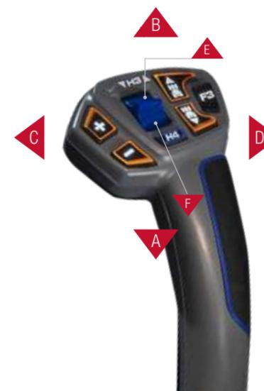
L'esclusivo joystick multifunzione disponibile su richiesta semplifica il controllo del caricatore, fornendo un'altra opzione inversore, oltre alla possibilità di regolare la velocità del trattore. Forche mordenti e altri attrezzi possono essere azionati facilmente grazie al controllo proporzionale del terzo distributore, mentre si ribalta o si riempie un attrezzo contemporaneamente.
