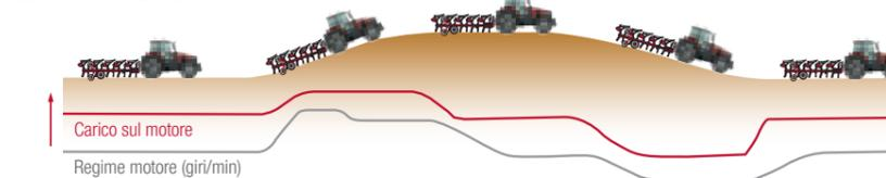
▶ L'apprezzata trasmissione a variazione continua Dyna-VT è ora dotata di una nuova modalità automatica. Consente all'operatore di usare la leva MultiPad o il pedale per variare la velocità di avanzamento, impostando automaticamente il regime del motore ottimale in base al carico e alla velocità. Oltre a garantire un funzionamento più fluido, riduce il consumo di carburante.
