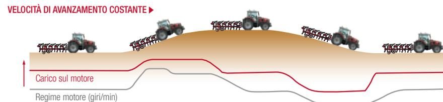
▲ L'apprezzata trasmissione a variazione continua Dyna-VT è ora dotata di una nuova modalità automatica. Consente all'operatore di usare la leva Multipad o il pedale per variare la velocità di avanzamento, impostando automaticamente il regime del motore ottimale in base al carico e alla velocità. Oltre a garantire un funzionamento più fluido, riduce il consumo di carburante.
