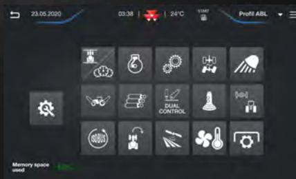
◀ **Funzionalità per la gestione completa e l'ottimizzazione delle funzioni del trattore** come la trasmissione, il motore e l'impianto idraulico. È inoltre disponibile lo straordinario sistema Dual Control che offre un controllo eccellente degli aratri semiportati automatizzando l'entrata e l'uscita dal solco. Simultaneamente, il sistema regola la profondità delle ruote dell'aratro rispetto al sollevatore posteriore.
