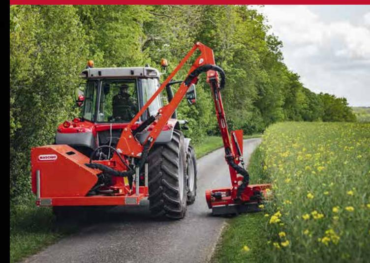
La cabina panoramica della serie MF 6S offre una visibilità senza ostacoli sul lato destro per poter utilizzare in modo sicuro ed efficiente gli attrezzi montati lateralmente. L'ampio vetro laterale in policarbonato è estremamente robusto e protegge l'operatore dai detriti.
