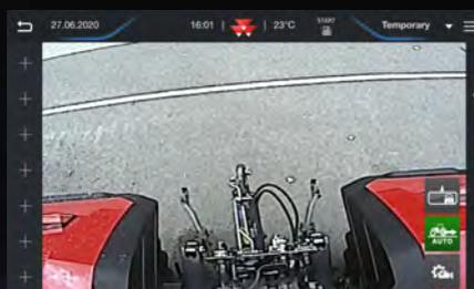
◀ **Modalità video\*** (disponibile tramite AGCO Parts per le versioni Efficient ed Exclusive) – Le immagini dalla telecamera a bordo possono essere visualizzate sullo schermo della console per consentire agli operatori di monitorare attrezzi complessi o semplicemente per migliorare la sicurezza e l'efficienza durante la retromarcia.
