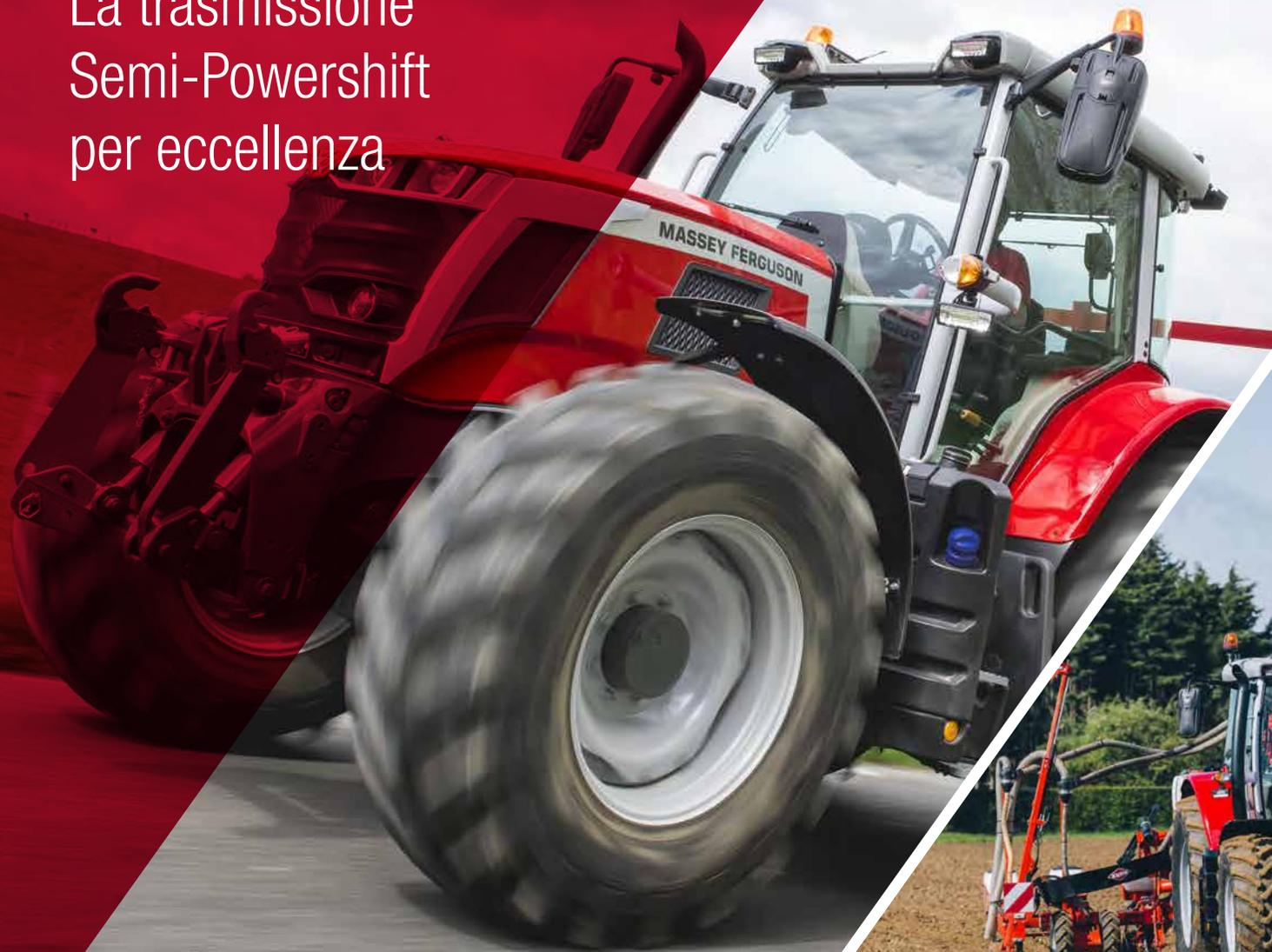
Dyna-6 Super Eco offre sei marce Powershift in quattro gamme per **la massima facilità sul campo e sulla strada**. Un totale di 24 velocità in entrambe le direzioni significa che è disponibile una velocità adatta praticamente per qualsiasi operazione, mentre la velocità di trasporto massima è pari a 40 o 50 km/h\* e raggiungibile ai bassi regimi del motore.
