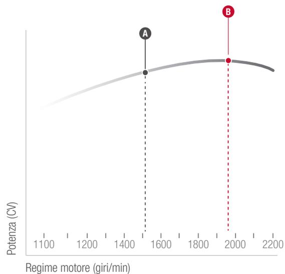
L'abbinamento tra le velocità della PTO e il regime del motore è stato concepito per garantire un utilizzo ottimale della potenza e della coppia del motore AGCO POWER e, nel contempo, ridurre i consumi di carburante per una produttività e un'efficienza eccezionali.
