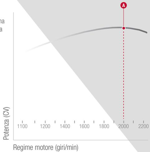
Questa curva mostra chiaramente come la coppia massima viene mantenuta fra 1.300 e 1.900 giri/min per garantire una riserva di coppia superiore e una velocità costante della PTO.
