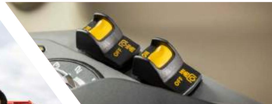
Selezione elettroidraulica della velocità della PTO
