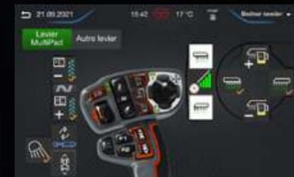
► **ASSEGNAZIONE DEI PULSANTI ISOBUS DELLA LEVA MULTIPAD** – Le funzioni degli strumenti ISOBUS più frequentemente utilizzate possono essere assegnate direttamente ai controlli sulla leva MultiPad. Questo consente di controllare mediante comandi fingertip e la stessa leva sia il trattore sia l'attrezzo.
