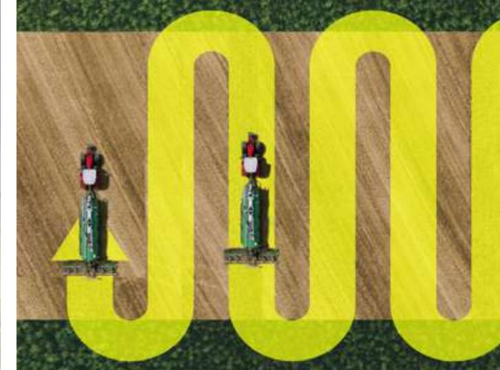
IL SISTEMA SPEEDSTEER riduce lo sforzo a carico dell'operatore e consente di eseguire sterzate più rapide, ottimizzando il tempo di lavoro utile rispetto alla capezzagna. L'operatore può regolare il rapporto di sterzo e selezionare il numero di rotazioni del volante necessarie a eseguire curve con un determinato angolo di sterzata.
