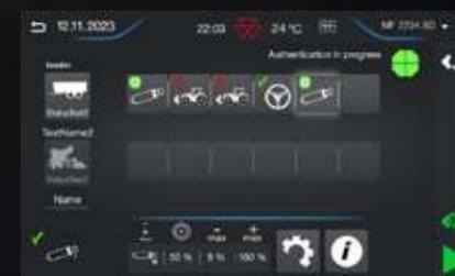
► **Il sistema ISOBUS TIM** offre il nuovo Tractor Implement Management (TIM) che gestisce automaticamente le funzioni del trattore, come la velocità di avanzamento e le operazioni idrauliche in base ai requisiti dell'attrezzo utilizzato. Questo sistema alleggerisce il lavoro a carico dell'operatore e migliora la qualità e l'omogeneità del lavoro.
