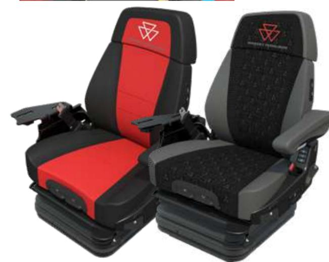
**SEDILI IN PELLE SU RICHIESTA** o in semi-pelle di serie. Entrambe le versioni offrono sedili girevoli a sospensione pneumatica automatica, ventilati, con due livelli di riscaldamento, ammortizzazione laterale e schienale Dual Motion, con sistema DDS (Dynamic Damping System)
