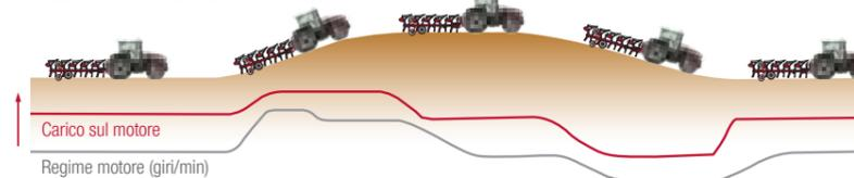
▶ In modalità automatica il trattore gestisce autonomamente il regime del motore in base alle variazioni del carico e della velocità di avanzamento. Funziona sia in modalità leva Multipad sia con leva a pedale, assicurando un funzionamento fluido e consumi ottimali.
