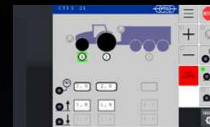
► **ISOBUS per un controllo totale degli attrezzi** – ISOBUS consente di visualizzare sul terminale il sistema di controllo del produttore dell'attrezzo, facendo risparmiare tempo e denaro ai proprietari e agli operatori evitando la necessità di installare monitor aggiuntivi in cabina oltre a quello del trattore. Collegate l'attrezzo alla presa ISOBUS del trattore per consentire al sistema di caricare i menu e di visualizzarli sullo schermo.
