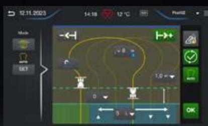
► **MF AutoTurn** – una nuova opzione del sistema MF Guide che, mediante tre modalità di sterzata per adattarsi all'attività in corso, sterza automaticamente il trattore indirizzandolo alla passata successiva. Due sequenze di manovra di fine campo e un nuovo sistema di gestione della manovra in capezzagna utilizzano il GPS per attivare le sequenze in base alla posizione rilevata del trattore.
