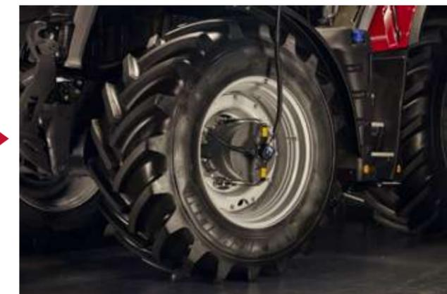
È dimostrato che il sistema Central Tyre Inflation riduce i consumi di carburante del 10-15% e la compattazione del terreno grazie a un'impronta fino al 150% più ampia. Nel contempo, può aumentare la trazione e ridurre l'usura superflua degli pneumatici.
