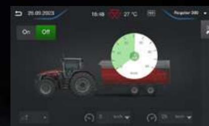
► **BLOCCO AUTOMATICO DELL'ASSE STERZANTE** – Questa funzionalità consente di definire la velocità a cui il trattore bloccherà automaticamente l'asse sterzante di un rimorchio, in modo da non doversi preoccupare del blocco dell'asse quando si eseguono trasferimenti in strada. Lo stesso accade quando si inserisce la retromarcia: tutto avverrà automaticamente.
