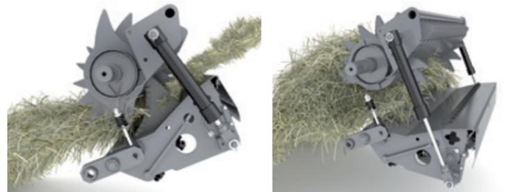
In caso di intasamento, l'operatore può facilmente aprire il convogliatore del piano di alimentazione e, contemporaneamente, abbassare i coltelli per aumentare lo spazio consentendo il passaggio del materiale.
