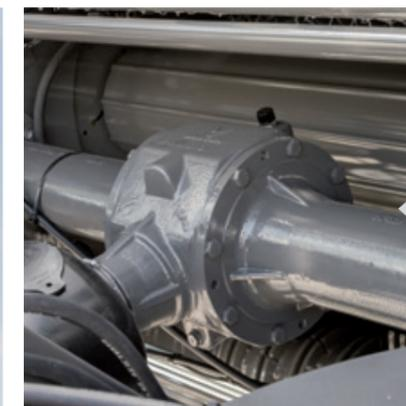
Il cambio Powersplit suddivide e trasferisce equamente la potenza per azionare l'unità rotore su un lato e i comandi dei rulli sull'altro, riducendo i requisiti globali di potenza e semplificando le trasmissioni. L'aggiornamento alla scatola del cambio a 1.000 giri/min include:
