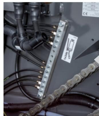
Una lubrificazione regolare e adeguata dei cuscinetti dei rulli è estremamente importante, in particolare in condizioni avverse, per esempio quando si producono balle di insilato. I banchi di lubrificazione centralizzati per i cuscinetti a rulli sono posizionati in punti estremamente accessibili per facilitare l'accesso e ridurre i tempi di intervento.
