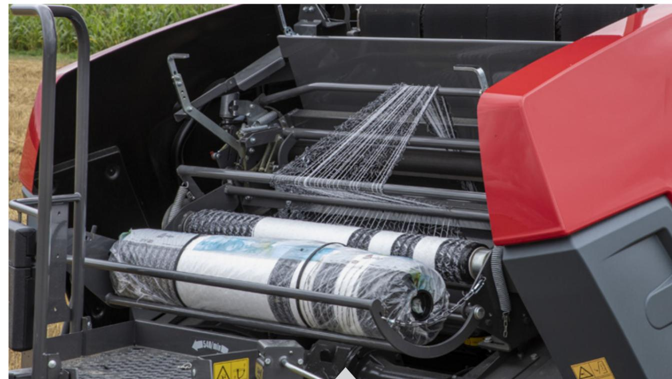
Il sistema **Easy Loading System (ELS)** consente di trasportare un rullo di rete di ricambio sulla pressa per eseguire l'eventuale sostituzione in pochi minuti. Oltre all'ELS è possibile installare un terzo rullo di rete supplementare sul lato sinistro della pressa, così da aumentare ancora di più la permanenza sul campo.
