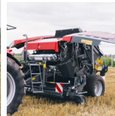
Gli sportelli laterali ad apertura completa semplificano l'accesso per la manutenzione. Le superfici lisce evitano l'accumulo di polvere tra i pannelli, mentre la robusta serratura impedisce aperture accidentali che potrebbero danneggiare la pressa.
