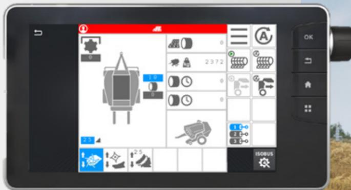
Sui trattori dotati di controllo ISOBUS è possibile utilizzare il monitor del trattore stesso per avere tutte le informazioni relative a trattore e pressa su un'unica interfaccia.
