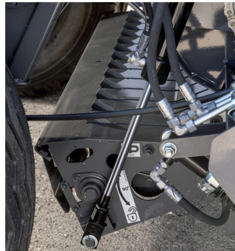
Il primo stadio del sistema Hydroflexcontrol consiste nel controllo del movimento della parte anteriore del piano di alimentazione. Questo sistema permette di evitare l'80% dei blocchi e di continuare a lavorare senza interruzioni.
