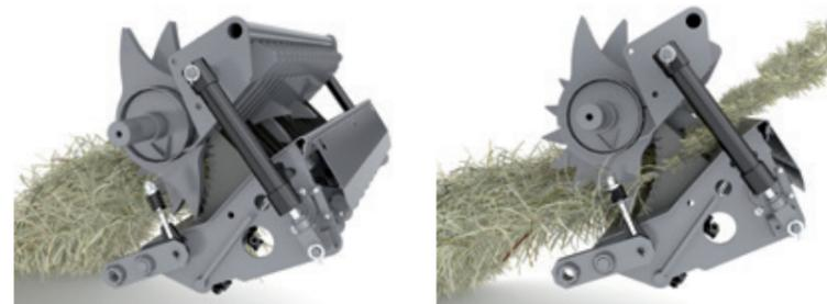
Il sistema di protezione brevettato impedisce ai picchi di materiale di provocare un intasamento abbassando delicatamente il piano di alimentazione, sospeso su tasselli di gomma o molle di acciaio, a seconda del modello.
