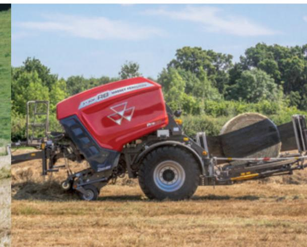
Per scaricare le balle delicatamente, il pianale dell'unità di fasciatura è ribassato per diminuire la velocità di rotazione della palla che in questo modo non si danneggia durante la posa e preserva la sua forma ideale. Un sistema di ribaltamento (optional) consente inoltre di posare le balle sui lati, per evitare che rotolino e per caricarle più agevolmente sul rimorchio. L'operatore può scegliere tra la modalità di scarico manuale o automatica.
