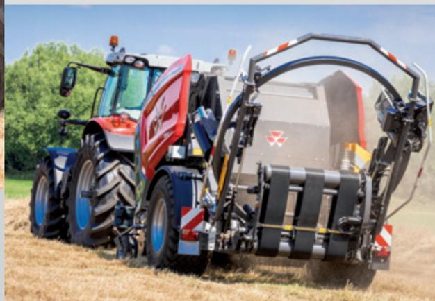
In modalità di trasporto l'anello di fasciatura viene ribaltato in avanti, riducendo così la lunghezza complessiva a soli 5,9 m per la massima manovrabilità e facilità di trasporto.
