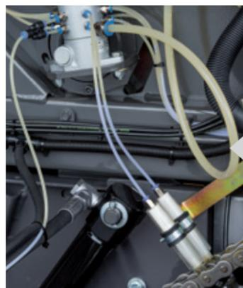
La lubrificazione automatica con regolazione specifica per ciascuna catena garantisce sempre l'apporto corretto di olio, una manutenzione limitata e una lunga durata della catena. Per una durata ancora maggiore, abbiamo scelto di installare esclusivamente catene di qualità certificata.
