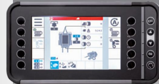
Il monitor E-Link Pro con tecnologia ISOBUS integrata, di serie sul modello MF RB 3130F Protec e optional sul modello MF RB 3130 F Xtra, permette all'operatore di visualizzare un gran numero di parametri, informazioni e regolazioni attraverso un ampio schermo ad alta definizione. La combinata pressa e unità di fasciatura è inoltre equipaggiata con una telecamera posteriore per il monitoraggio della fasciatura.
