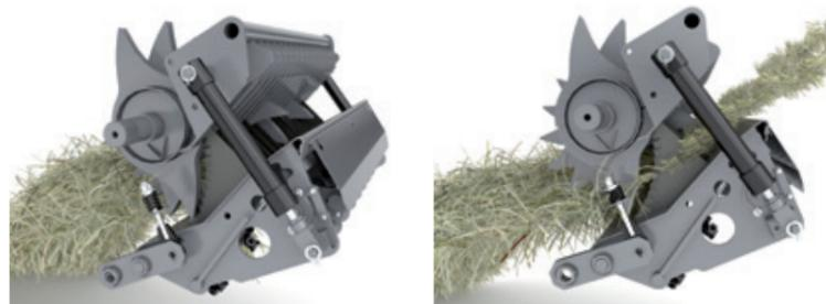
Il sistema di protezione brevettato impedisce ai carichi di picco di provocare intasamento abbassando delicatamente il convogliatore, sospeso su tasselli di gomma o molle di acciaio, a seconda del modello.
