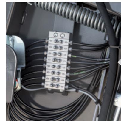
Una lubrificazione regolare e adeguata dei cuscinetti dei rulli è estremamente importante, in particolare in condizioni avverse, per esempio quando si producono balle di insilato. I banchi di lubrificazione centralizzati per i cuscinetti a rulli sono posizionati in punti estremamente accessibili per facilitare l'accesso e ridurre i tempi di intervento.
