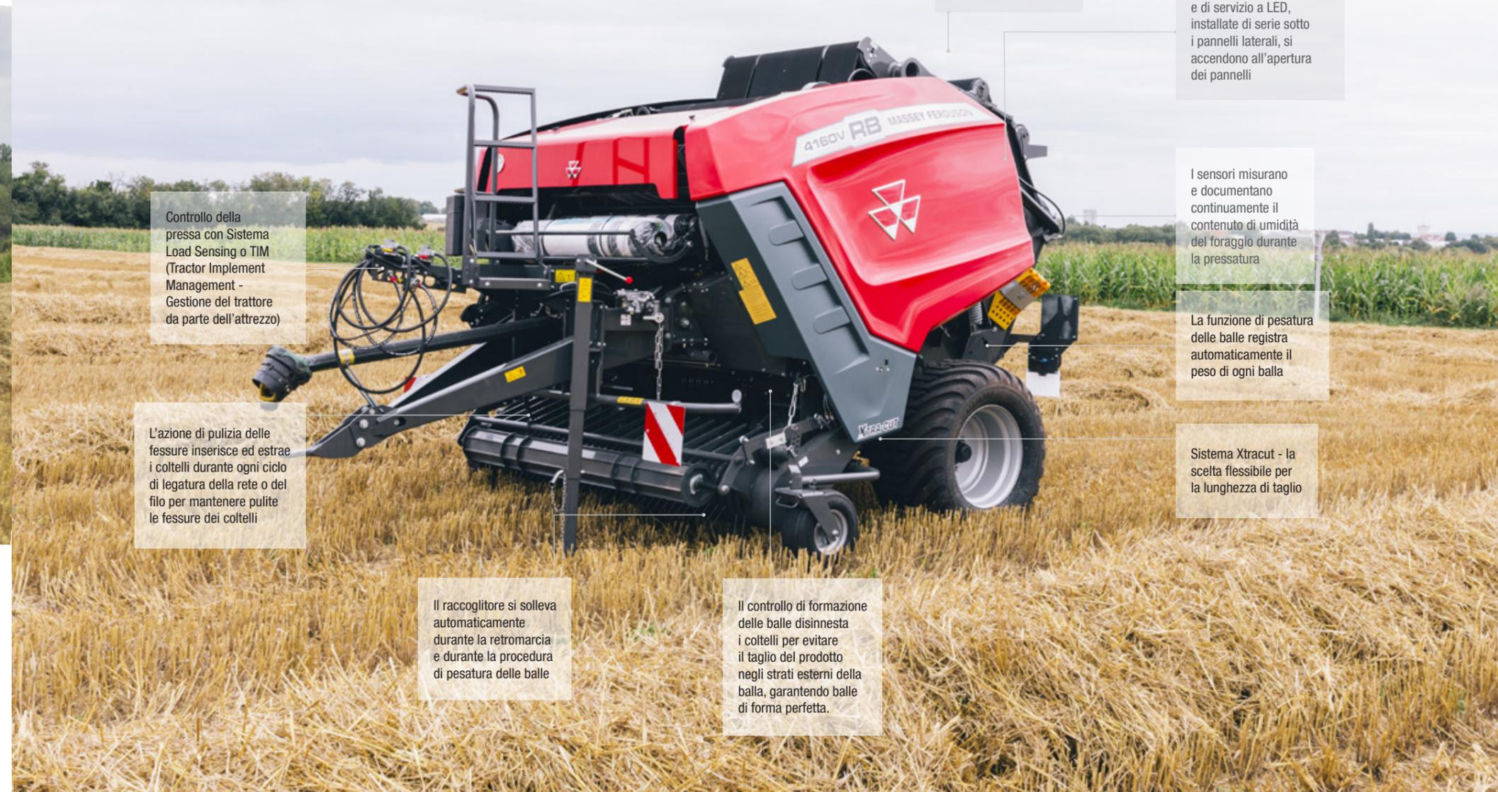
Il portellone si apre e si chiude automaticamente per scaricare le balle non appena termina il processo di legatura
